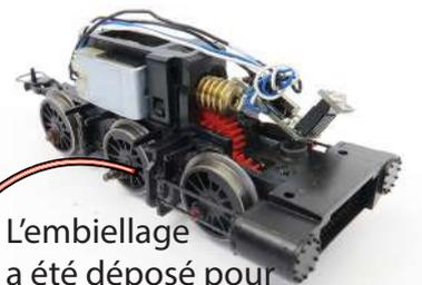
L'embellage a été déposé pour être décapé : dévissage des écrous six pans, immersion des bielles et écrous dans un bain de décapant, rinçage et remontage.
